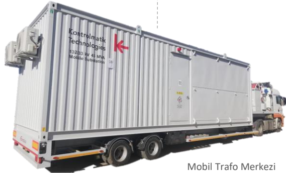
Mobil Trafo Merkezi
